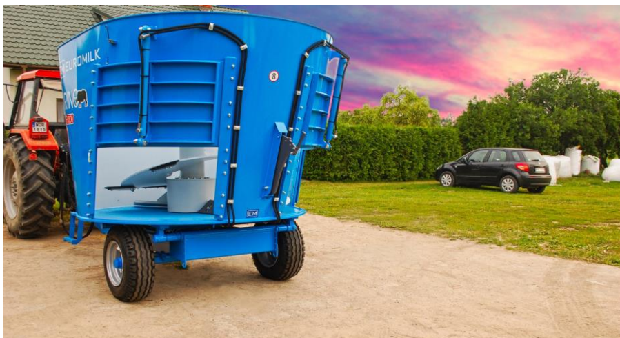
Výpustné okno 120 x 84 cm (základné prevedenie bez PVC dopravníka)
