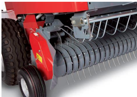
Zberač šírka 2 m, bočné podávacie šneky
