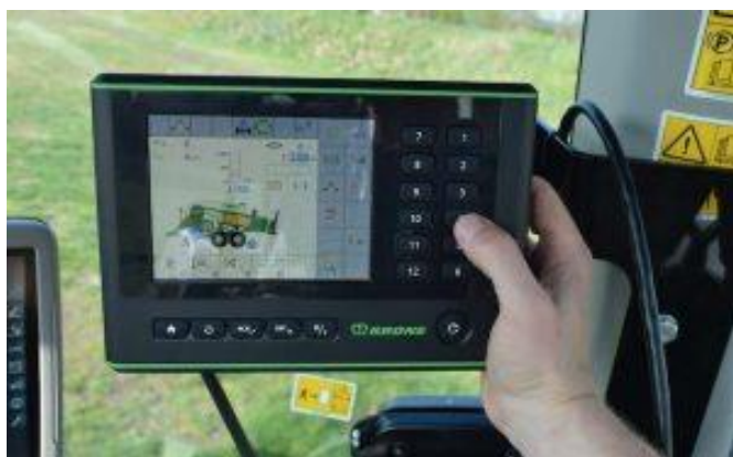
Ovládací terminál DS 500 In-Cab : obrazovka 5,7“, 12 tlačídel, otočný ovládač
