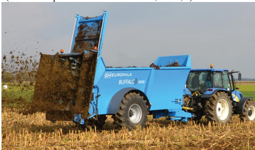
Obr. Zadný hydr. štít (gilotina) + bočné otvárateľné deflektory
