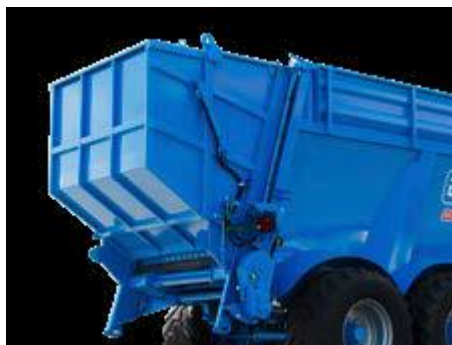
zadný nastavac hydr. výklopný + 4 m 3 . Po demontáži rozmetacieho ústrojenstva nastavba slúži na zvoz senáže, siláže
