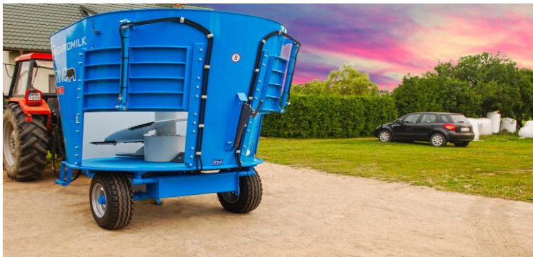
Výška okna od zeme 500 mm, šírka 0,9 m
