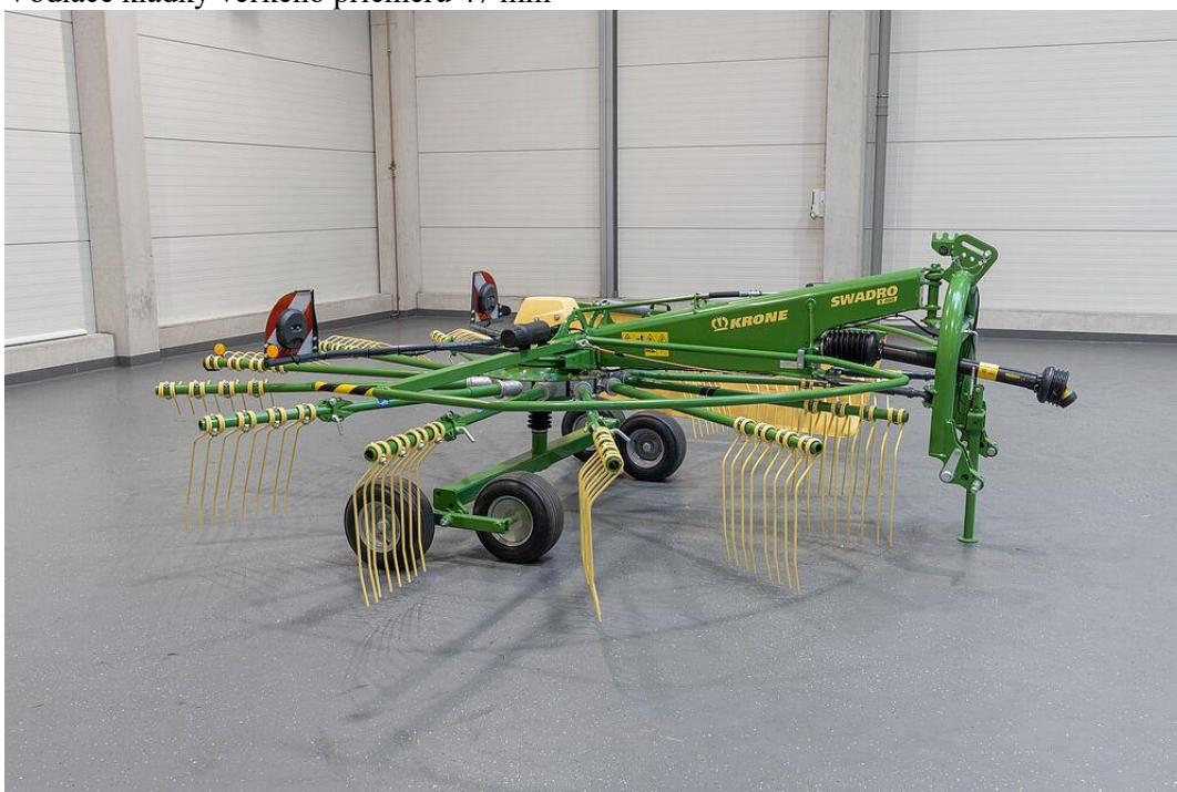
Tandemový podvozok, predná náprava s nábehom Jet Efect, zadná rozšírená
