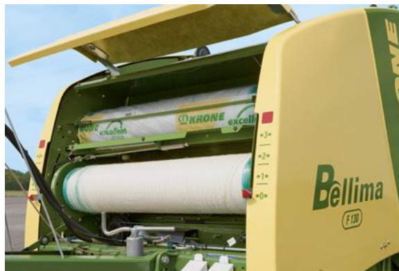
viazanie do siete + stranové ukazovatele tvaru Balíka a stupňa zlisovania
