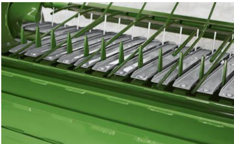
Zberač s hrablicovým podávačom hmoty do lisovacej komory, + stranové podávacie šneky
